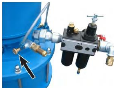
Рис. 26 Регулировочный винт устройства для устранения обледенения
