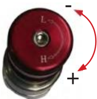
Рис. 43: Настройка давления на регуляторе циркуляции материала
