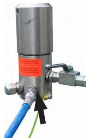
Рис. 30 Присоединение шланга для распыления к ВНФ
