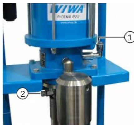
Рис. 47 Заполнение (1) и слив (2) разделительного средства для серий PHOENIX и SUPER
