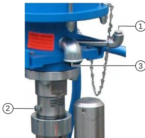
Рис. 45 Заполнение (1) и слив (2) разделительного средства для серии PROFESSIONAL и HERKULES
